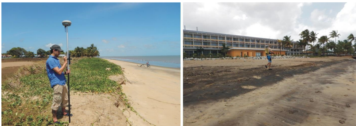
Figure 13 : Levés des profils de référence (à gauche) et de la position du trait de côte (à droite).
