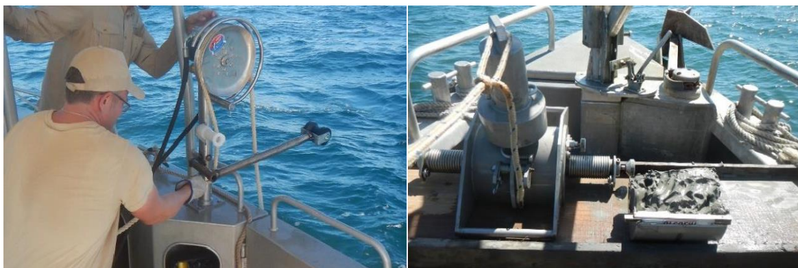
Figure 21 : Utilisation de la benne Schipeck© (à droite ; BRGM, 2019) à l'aide d'un tire casier (à gauche ; BRGM, 2020) à tribord du navire.
