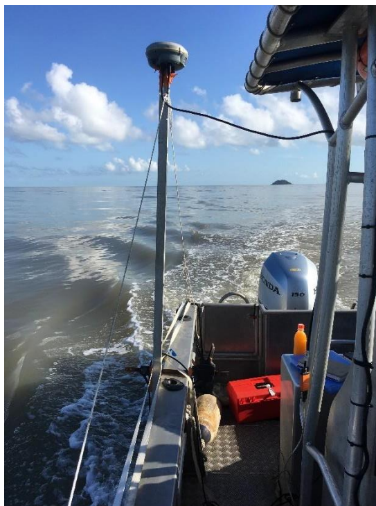
Figure 15: Installation de la sonde mono-faisceau mono-fréquentielle couplée avec le DGPS-RTK avec le système de correction TERIA.
