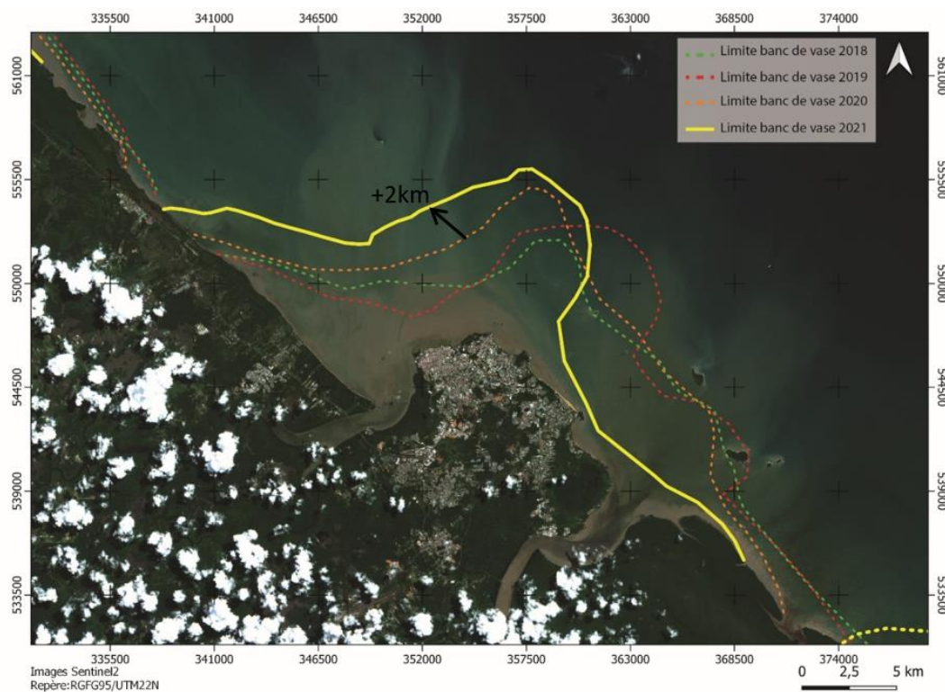
Figure 25: Limite du banc de vase subtidale obtenue selon la limite d'atténuation de la houle à partir des images satellites Sentinel-2.
