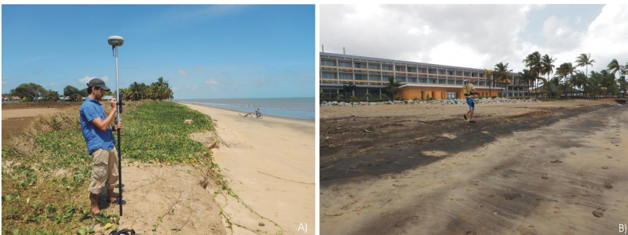
Figure 14 : Levés des profils de référence (A) et de la position du trait de côte (B).
