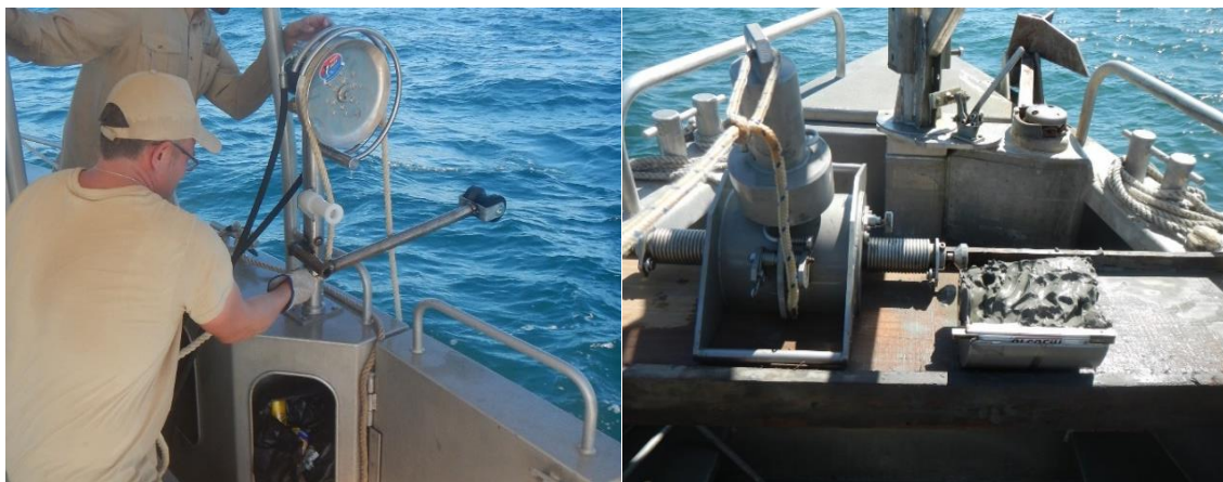
Figure 23 : Utilisation de la benne Schipeck (à droite ; BRGM, 2019) à l'aide d'un tire casier (à gauche ; BRGM, 2020) à tribord du navire.
