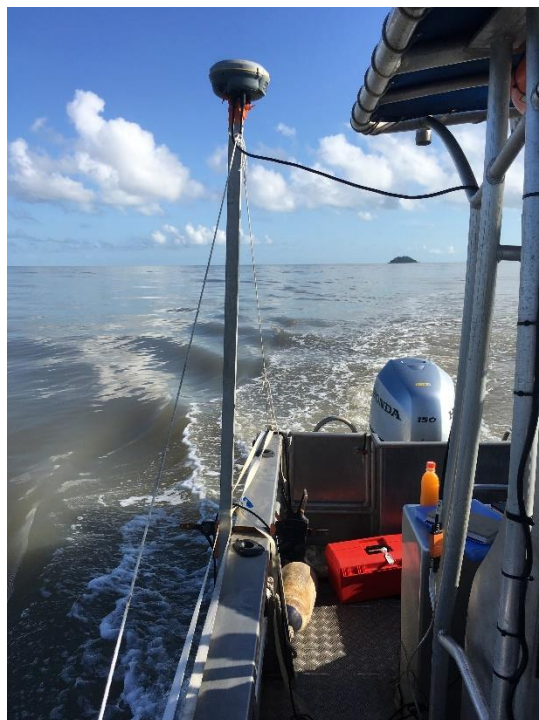
Figure 16 : Installation de la sonde mono-faisceau mono-fréquentielle couplée avec le DGPS-RTK avec le système de correction TERIA.
